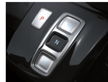
Берілістерді ауыстырып қосу электрондық басқарылатын АБАҚ (Shift-by-Wire)
